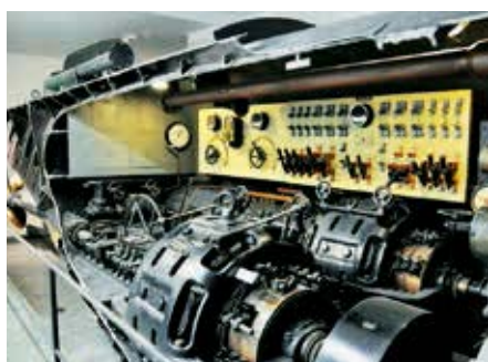
③輪切りにされたUポートのディーゼルエンジン部
