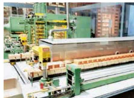
⑬ 建築用レンガの製造ラインのミニチュア模型 (可動)
