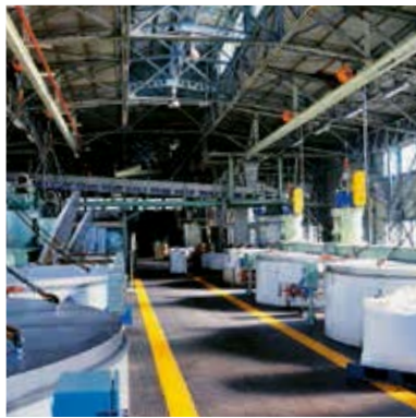
60トンの釜がなんと11基。1釜で約25万個の石けんが作られます。
