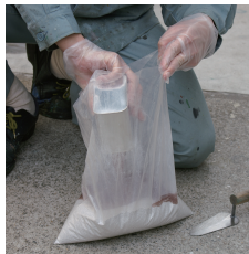
樹脂液の投入
