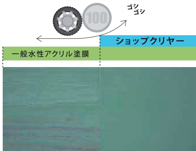
上図は一般水性アクリル塗料の上にショップクリヤーを塗装してタイヤ片およびコインで擦りつけたときの汚染・擦り傷の状態を表しています。
