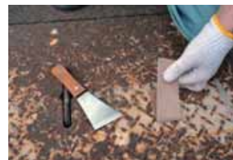
皮スキヤガムテープにて付着強度の確認を行う。
