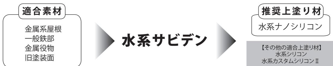
※屋根用上塗り材には水系ナノシリコンが最適です。他の上塗り材は屋根役物や一般鉄部などで小面積の部分にご使用ください。
