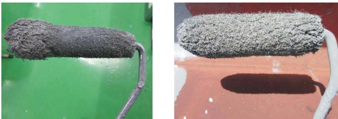
写真3 夏場塗装後のローラー（左：水系ハイエボン 右：水系ハイエボンⅢ）
