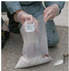
樹脂液の投入
